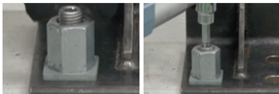
④止めねじをセットし、ヘキサゴンヘッドのトルクレンチで規定値まで締め込んで完了。(合いマークをつけることをおすすめします。)
