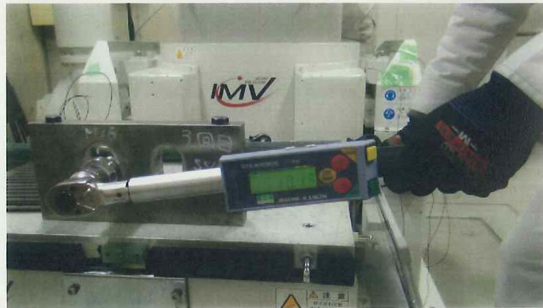
写真6-1 3回目試験前M16 本体の締付確認(上)とトルク値(下)
