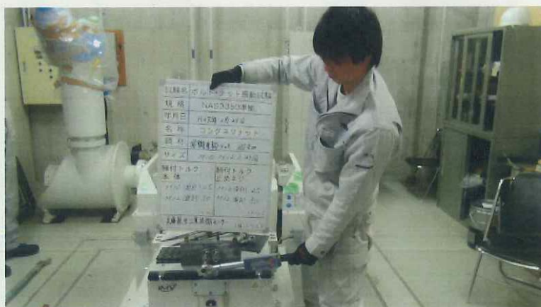
写真 2-1 2回目試験前M10 本体の締付確認(上)とトルク値(下)
