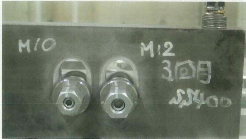
写真3-5 3回目試験後のM10 M12(上)と回転確認(下)
