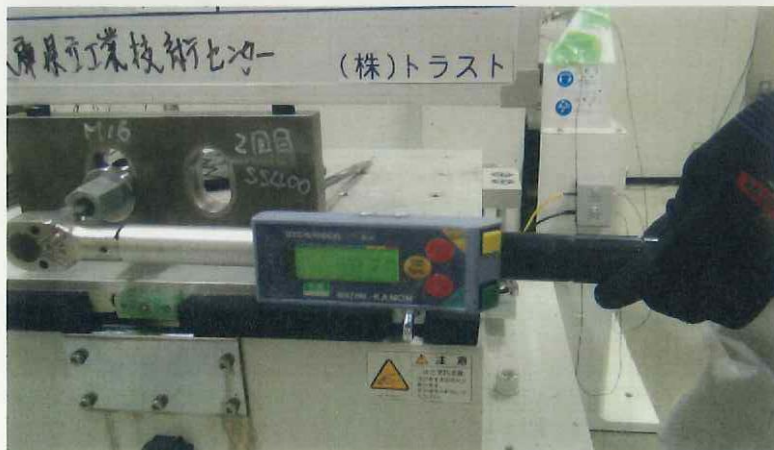
写真5-2 2回目試験前M16 止ネジの締付確認(上)とトルク値(下)
