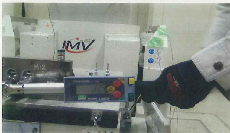
写真 3-1 3回目試験前 M10 本体の締付確認 (上) とトルク値 (下)
