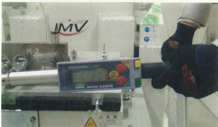
写真 3-2 3回目試験前 M10 止ネジの締付確認 (上) とトルク値 (下)
