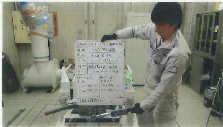
写真 2-3 2回目試験前M12 本体の締付確認(上)とトルク値(下)
