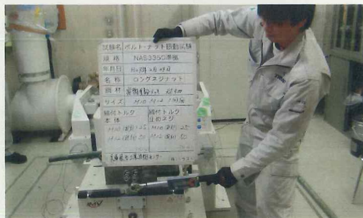
写真1-3 1回目試験前M12 本体の締め確認(上)とトルク値(下)
