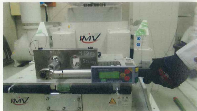
写真6-2 3回目試験前M16 止ネジの締付確認(上)とトルク値(下)
