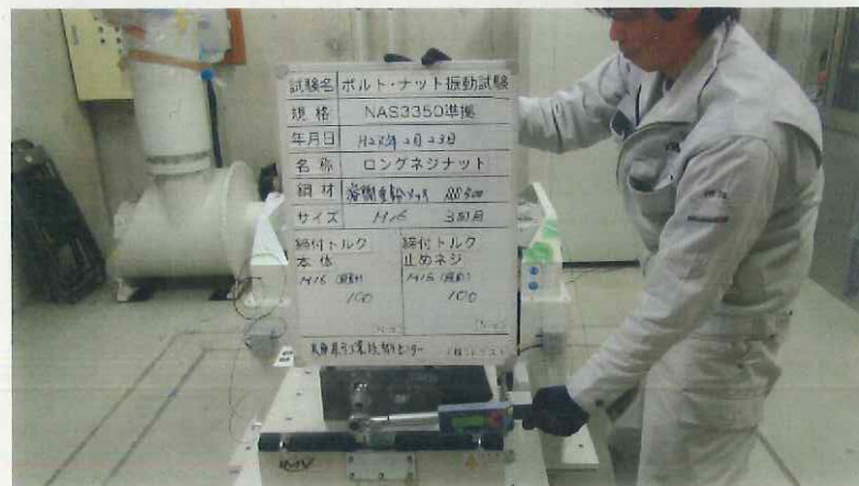
写真6-1 3回目試験前M16 本体の締付確認(上)とトルク値(下)
