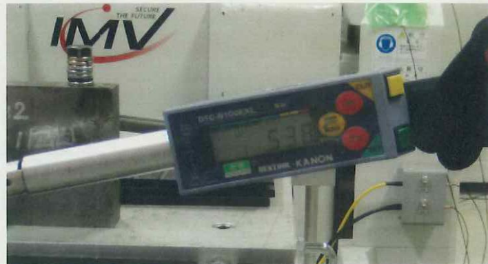
写真1-3 1回目試験前M12 本体の締め確認(上)とトルク値(下)
