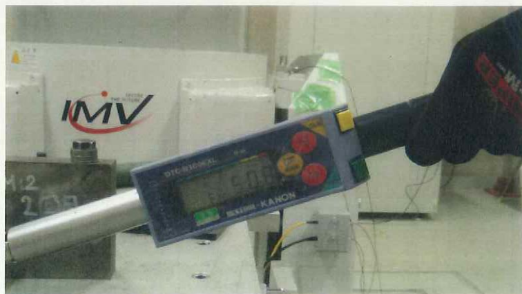
写真 2-4 2回目試験前M12 止ネジの締付確認(上)とトルク値(下)
