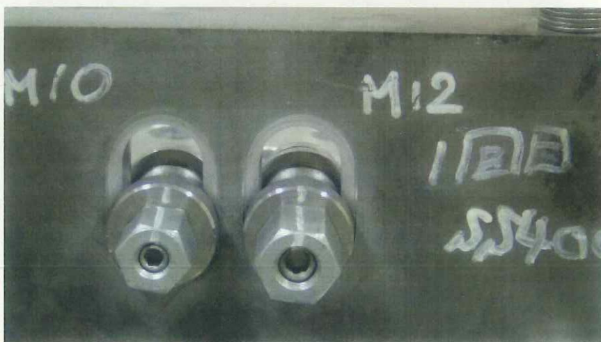
写真 1-5 1回目試験後のM10 M12(上)と回転確認(下)
