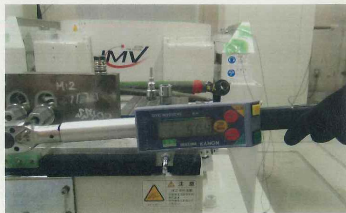
写真1-4 1回目試験前M12 止ネジの締め確認(上)とトルク値(下)
