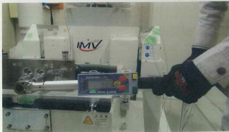
写真3-4 3回目試験前M12 止ネジの締付確認(上)とトルク値(下)
