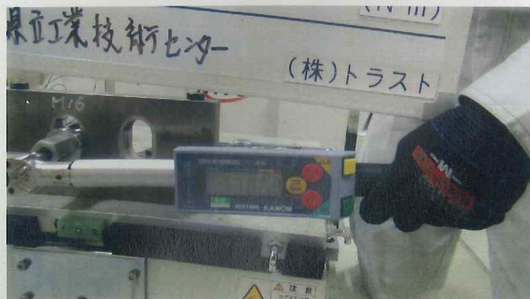
写真4-2 1回目試験前M16 止ネジの締付確認(上)とトルク値(下)
