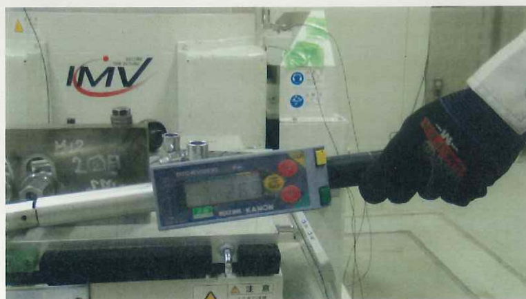
写真 2-2 2回目試験前M10 止ネジの締付確認(上)とトルク値(下)
