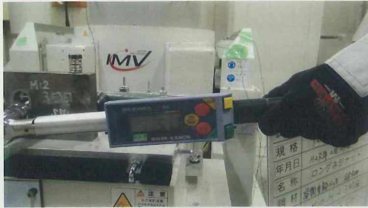
写真3-3 3回目試験前M12 本体の締付確認(上)とトルク値(下)
