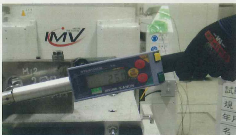
写真 2-1 2回目試験前M10 本体の締付確認(上)とトルク値(下)
