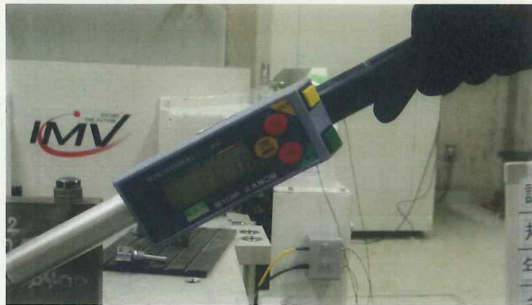
写真 2-3 2回目試験前M12 本体の締付確認(上)とトルク値(下)
