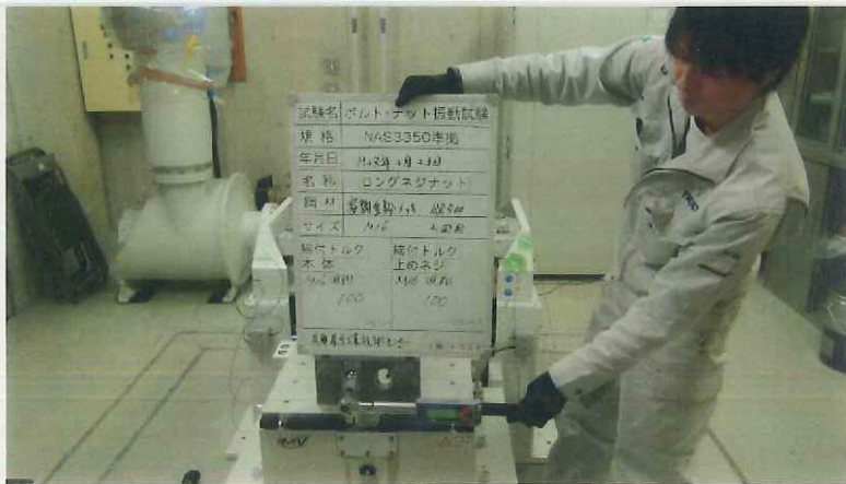
写真5-1 2回目試験前M16 本体の締付確認(上)とトルク値(下)
