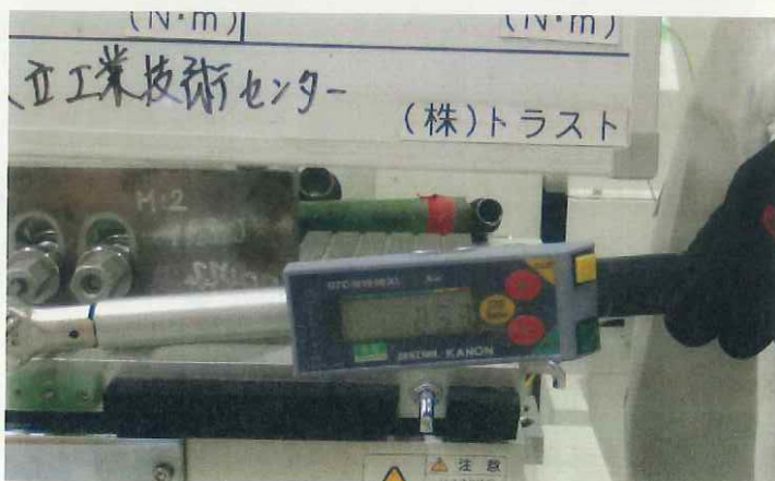
写真 1-2 1回目試験前M10 止ネジの締付確認(上)とトルク値(下)
