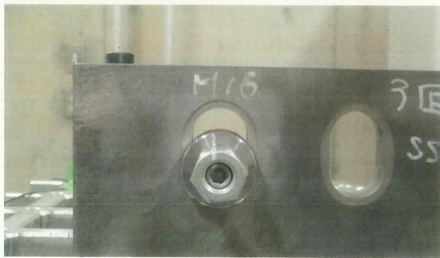
写真 6-3 3回目試験後のM16(上)と回転確認(下)
