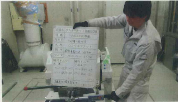
写真3-3 3回目試験前M12 本体の締付確認(上)とトルク値(下)
