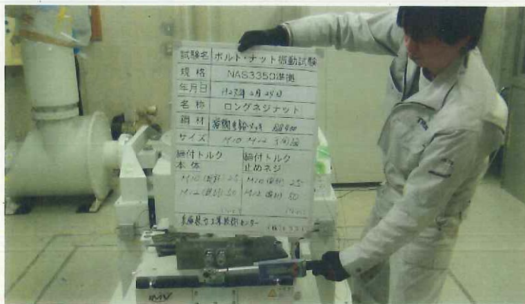
写真 3-1 3回目試験前 M10 本体の締付確認 (上) とトルク値 (下)
