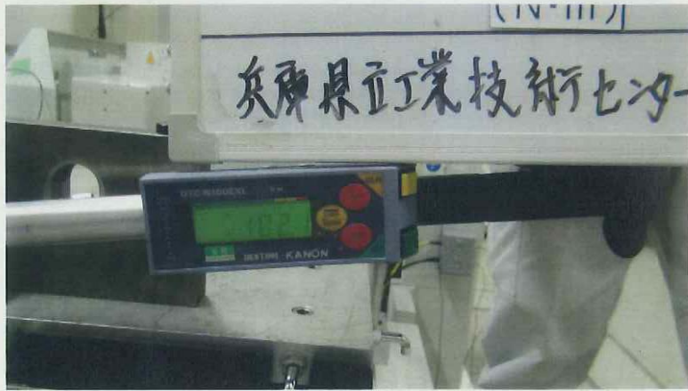
写真4-1 1回目試験前M16 本体の締付確認(上)とトルク値(下)
