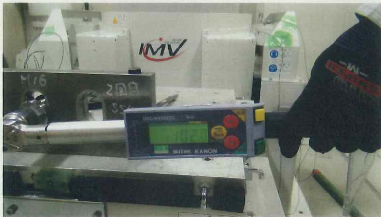
写真5-1 2回目試験前M16 本体の締付確認(上)とトルク値(下)
