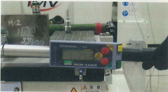
写真 1-1 1回目試験前M10 本体の締付確認(上)とトルク値(下)
